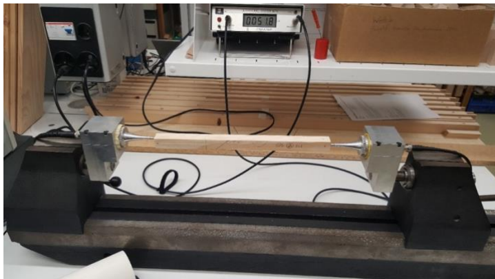
Fig. 6 : Test acoustique d'éprouvettes longues (Ultrasonic Tester BPV Steinkamp)
