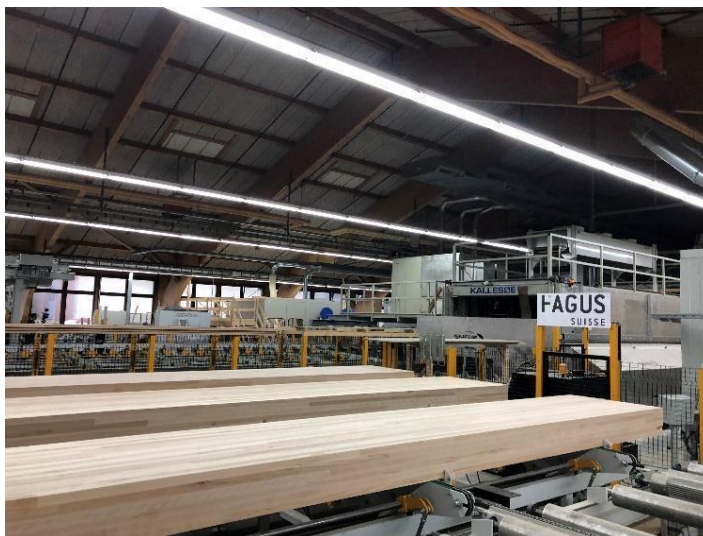
Poutres en hêtre "fraîches de la presse" dans l'usine de production de Fagus Suisse.
